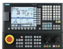
SIEMENS 808D CONTROLLER
